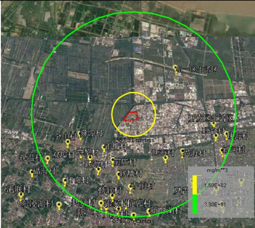
图 7.4-20 最不利气象条件下 HCl 扩散图
